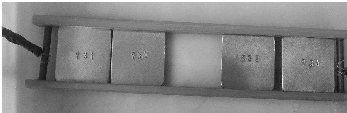
Obr. 1. Korozní destičky v rámečku před uložením
